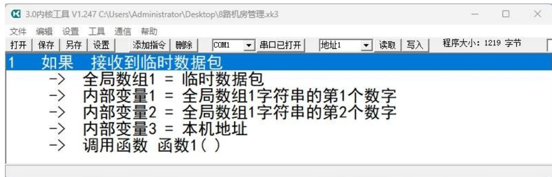
函数 1：设置功能码“open”为开机，“close”为关机，“chaxun”为查询主机状态。**接收到的字符串必须以功能码开头**。字符串中第 1 组数字代表模块地址，地址范围 0-255 或者 10000（总线上所有地址主机），**所接收到的字符串地址必须正确**，否则程序不执行。
