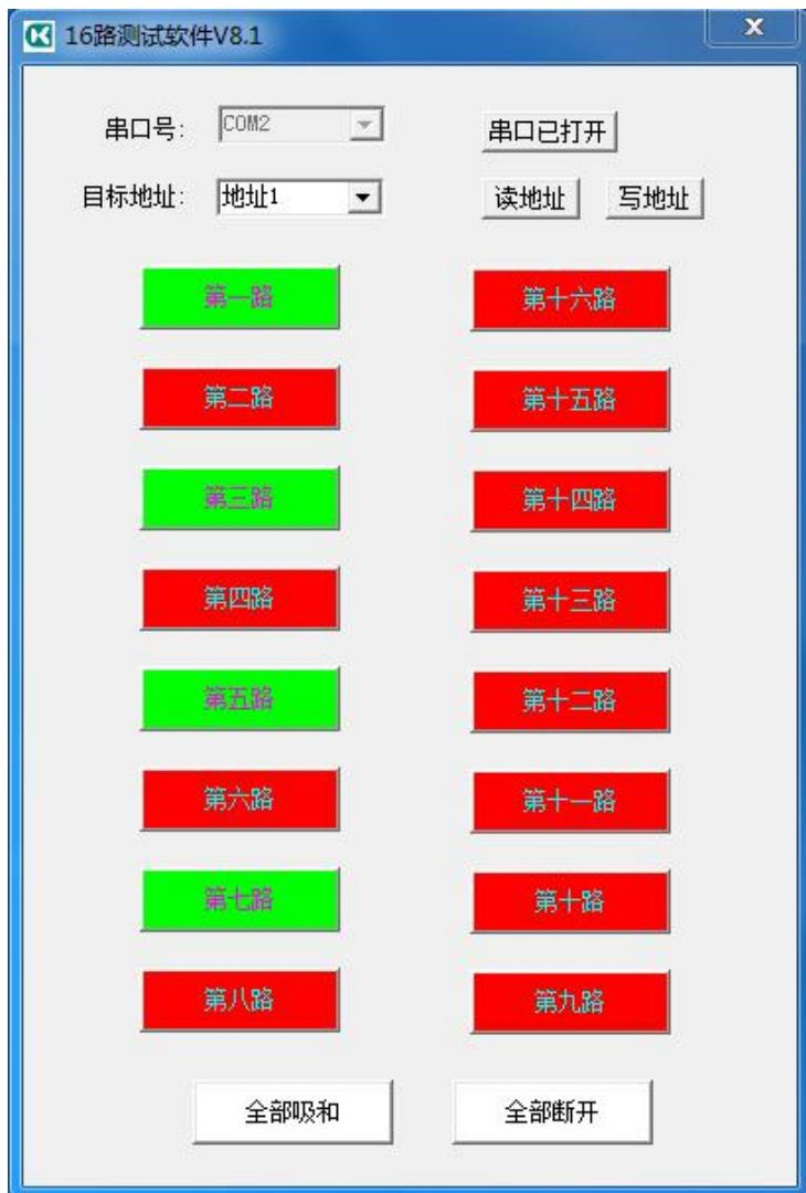
上图为继电器控制板与软件连接成功后图示，产品出厂设置地址为1，软件可以控制继电器动作，并显示继电器状态，软件图标红色代表断开，绿色代表闭合。
